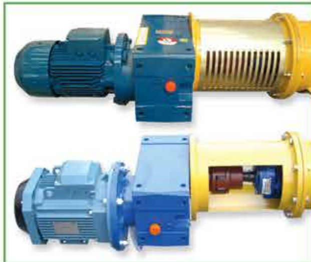
Elastik Kaplin Bağlantı Detayı Elastic Coupling and Protection Details
